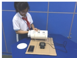
安裝吸音機艙壁並進行測試
