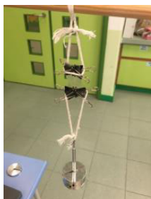
圖2.2 薯粉2的拉力測試
