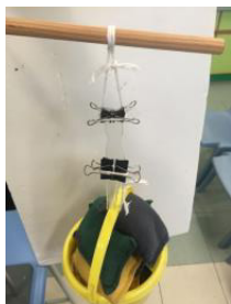
圖2.1 粟粉1的拉力測試
