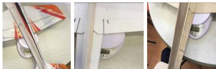
三種環保飛機在風扇機啟動前後的重量差異，即為升力。
