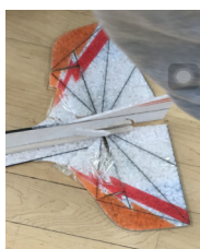
EPP機損毀情況
