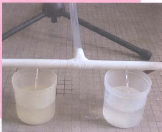
(調整出水孔大小以及硬喉水平斜度，可令兩盆栽得到相近的水份)
