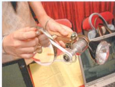
手動發電的電筒，不用電芯也可以作照明。 動力電筒 — 孔教學院大成小學
