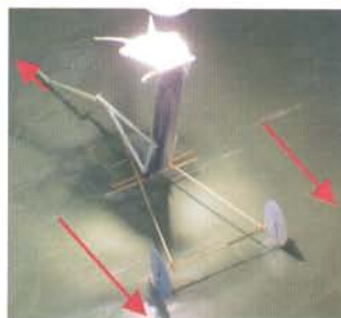
氣袋受熱膨脹上升，活動腳壓著地後，使車向前推進
