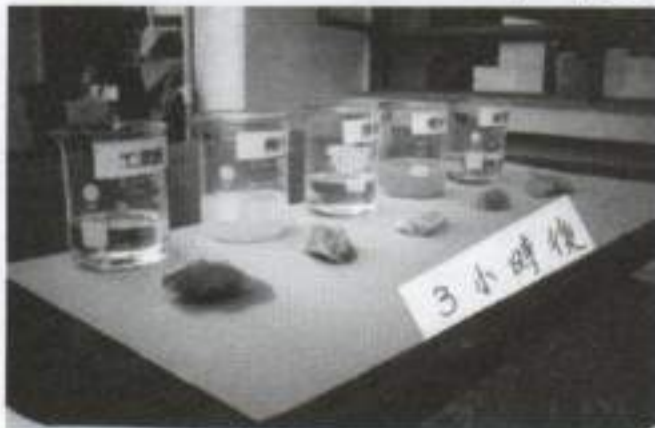
三個小時後，在工業醋中的豬肉已變硬，外層呈透明
