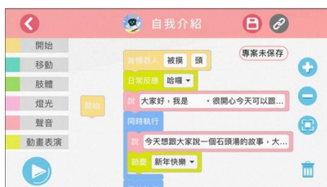
圖2 使用手機積木程式工具操控機器人之介面
