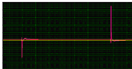
圖9 開關閉合斷開暫態，電壓波形
