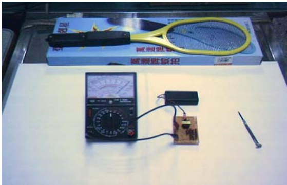
照片一:以多用途電表測量輸出電壓上限
