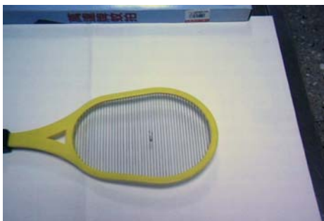
照片三:在電網線上加上兩個放電接點
