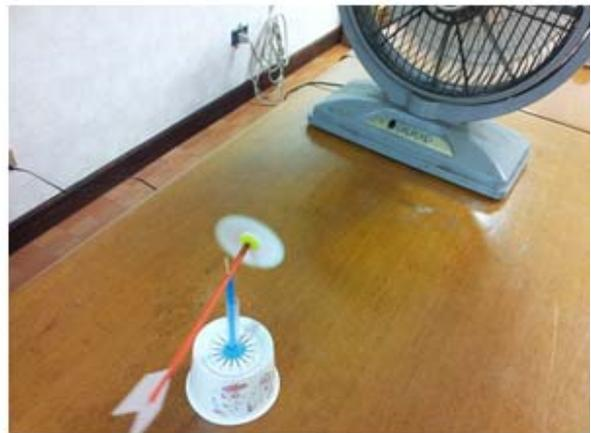
图七: 风车型风向仪指向风来的方向
