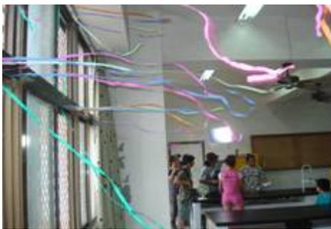
圖 16：打開上層氣窗、吊扇反轉，氣流由外往內飄動
