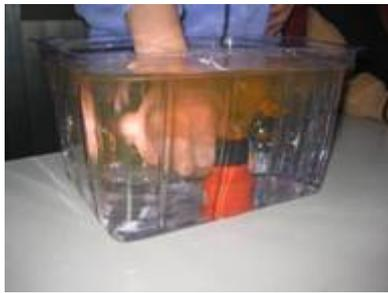
圖 3-1、瓶蓋鑽孔的溫熱紅墨汁，用姆指按住瓶蓋，放入冷水底部。
