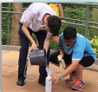
◀ 圖十七：參加者親自於園內的大型魚菜共生系統取水，將水樣本帶回實驗室作分析，嘗試找出系統水質淨化的效能。
